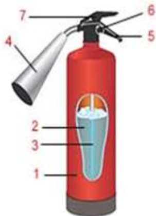
Рис. 8. Конструкция переносного углекислотного огнетушителя.
