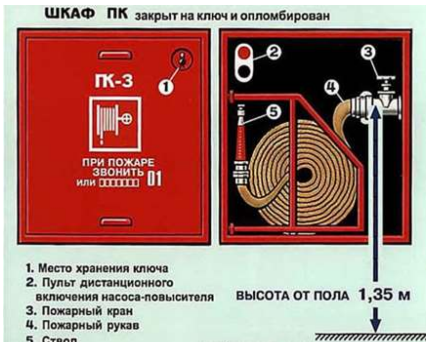
Рис. 13. Требования к размещению внутреннего пожарного крана.
